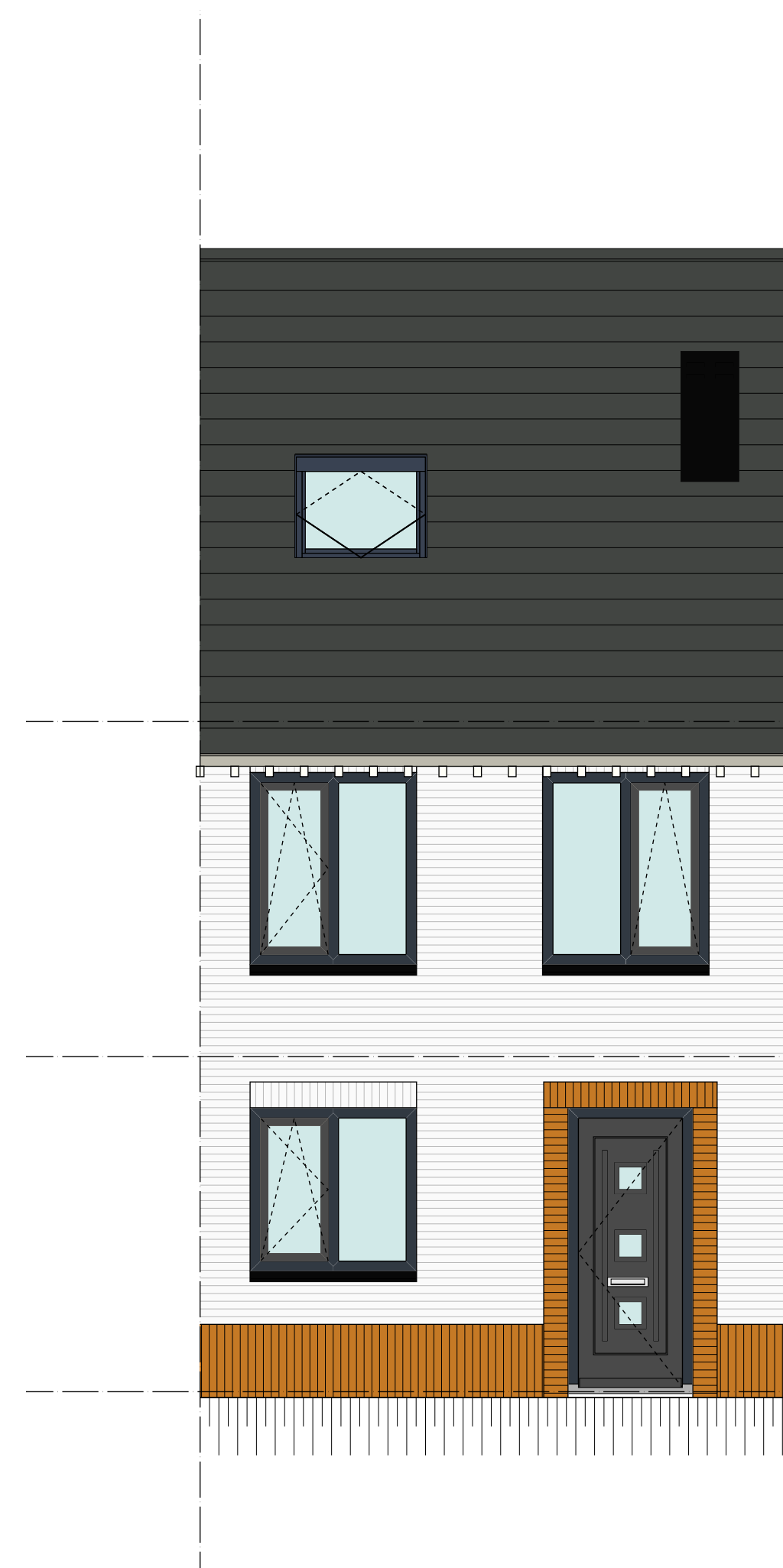
voorgevel getekend type R - optie dakraam zolder
