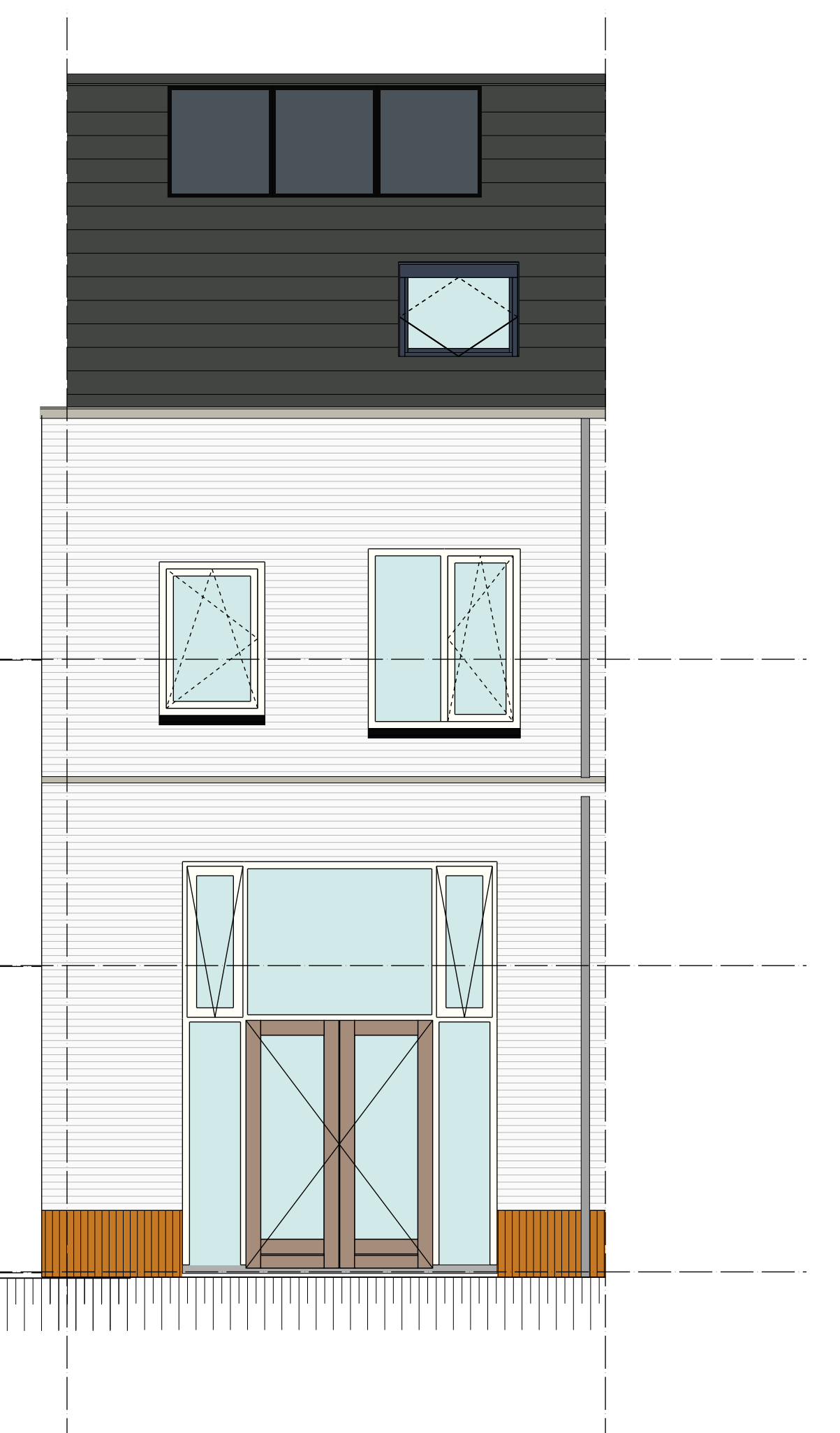
achtergevel getekend type Q - optie uitbouw 1.2 / 2.4 meter
